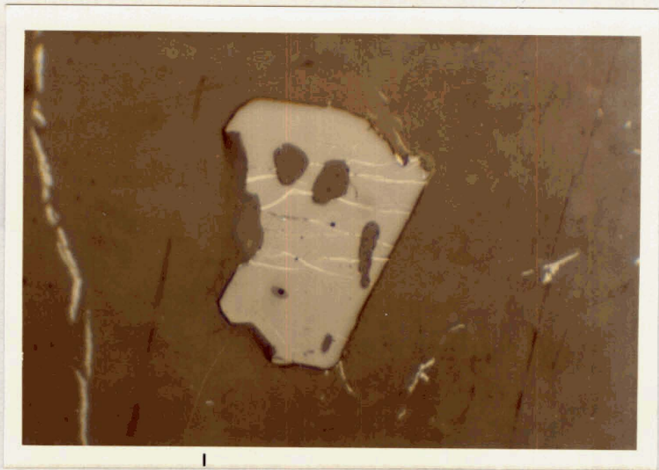
Fotomicrografía 1: Grano de cromita, atravesada por ve tas de magnetita, alterándose a mar- tita. Sección pulida. Nicoles paralelos. N 225 aumentos.
